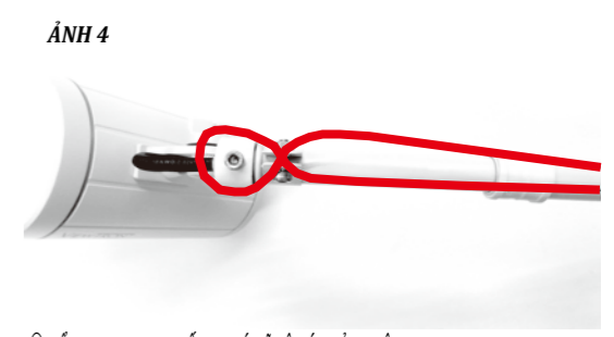
④ KIỂM TRA XEM BULONG CỐ ĐỊNH GIÁ CỬ DÂY CÓ BỊ LÔNG KHÔNG. KHI NHÌN TỪ TRÊN XUỐNG, DÂY SẼ CÓ HÌNH DẠNG GIỐNG SỐ 8 NHƯ THỂ NÀY.
